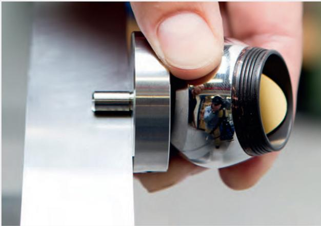
Punktreproduzierbarkeit  $\pm 20 \mu\text{m}$ , volumetrisch  $\pm 29 \mu\text{m}$
