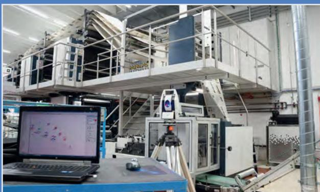
*Vermessung und Justierung einer Rotationsdruckmaschine*
