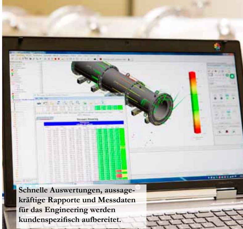
Für die Form- und Lageprüfung, selbst einfachster Bauteile, ist die 3D-Messtechnik unabdingbar
