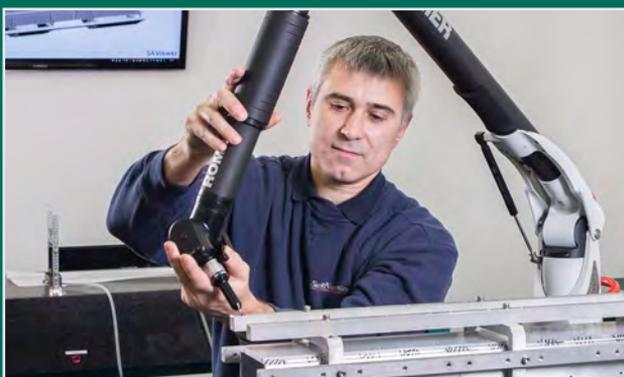
Vermessen von Schweisskonstruktionen mittels 3D-Messarm innerhalb der zugehörigen Vorrichtung (vor und nach Schweißen)
